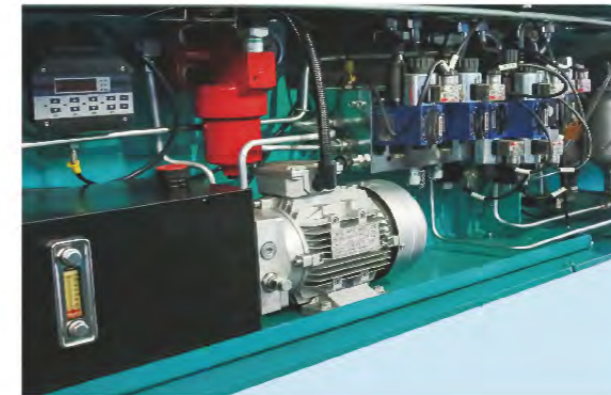
制动方式 Brake method 整机通过一套液压站提供制动动力及其他液动力 One set of hydraulic station provides brake force and other hydraulic power
