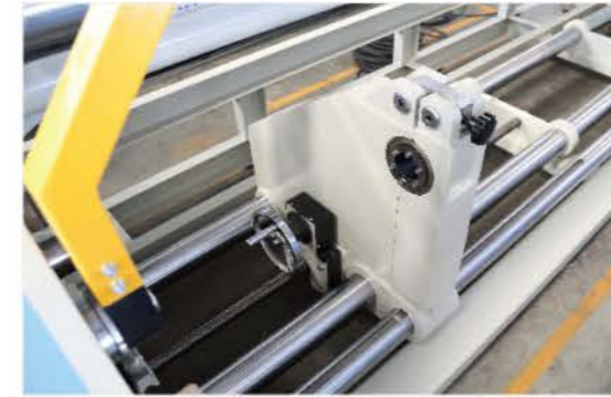
▲ 上下轴装置：气动式上下轴装置。 尾座手动调节。 Load/unload device: Pneumatic system. Tailstock manual adjust.
